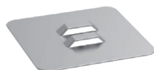
Corte e Dobra em Ponte
