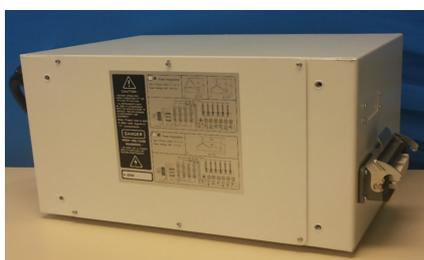
2.1- Verifique a placa de identificação para garantir que o sistema de controle foi ligado de acordo com a entrada de alimentação da fábrica.
