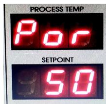
Quando o alarme TCA é identificado, o modulo de controle passa automaticamente para a função de “controle manual”.
