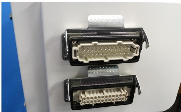
8.5 Controlador de 08 e 12 zonas, possuem 02 conectores na lateral do equipamento, sendo 01 para a energia e 01 para o termopar.
